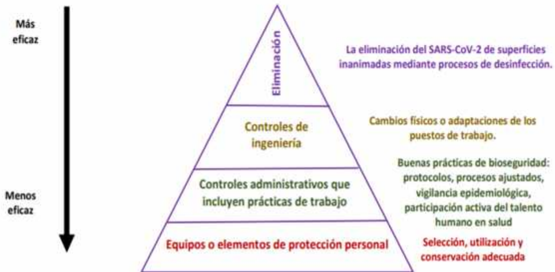
Figura. Jerarquía de los controles. Adaptado de la Figura 38-1 de Ladou Joseph, et al. (2015).
